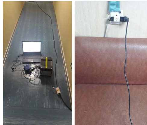
그림 6. 유도형 광대역 전력선 통신 시스템의 선박 적용 통신 성능시험. (a) 선박에 배치된 전력선 통신 시스템, (b) A 구역, (c) B 구역. Fig. 6. Ship performance test of inductive BPLC system. (a) inductive BPLC system deployed on ship, (b) Zone A, (c) Zone B.
