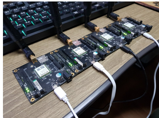
그림 1. TPB22-3 모듈이 포함된 개발보드 Fig. 1. TPB22-3 NB-IoT Module mounted EVK Board
