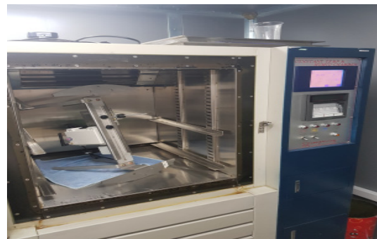
그림 9. 온습도 환경시험 챔버 Fig. 9. Temperature and Humidity Environmental Test Chamber
