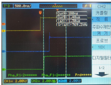
그림 10. 오실로스코프로 측정된 마스터(STM32F407 모듈)와 슬레이브들 (UART to Ethernet 모듈)의 PPS Fig. 10. PPS of master (STM32F407 module) and slaves (UART to Ethernet module) measured by oscilloscope
