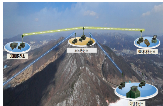
그림 5. 전술정보통신체계의 지상 무선백본 간선망 운용개념도 Fig. 5. Operation Concept of Ground Wireless Backbone Network
