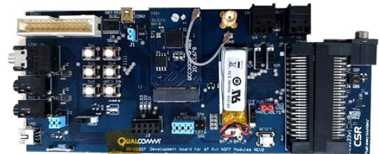
그림 5. QCC3005 테스트 보드
