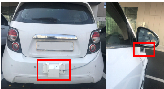
그림 2. 실험 차량의 레이더와 카메라 센서의 장착 위치 Fig. 2. Mounting position of the radar and camera sensors of the test vehicle.
