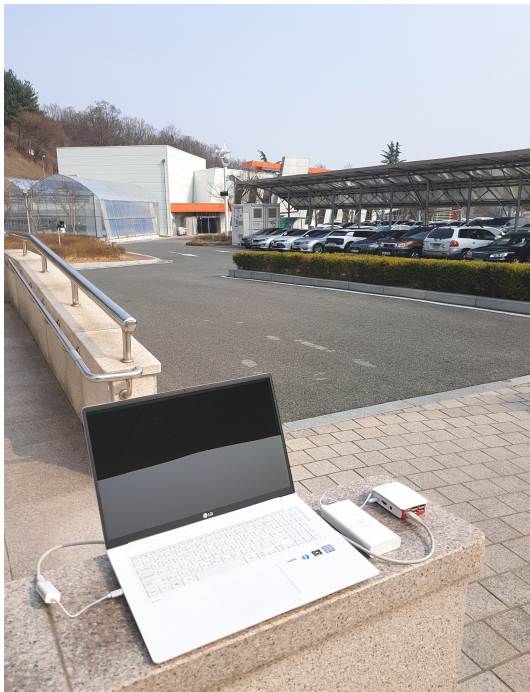
그림 21. PV 접속반으로부터 약 50m 떨어진 지점에서의 PV 스트링 무선 모니터링 수행 모습 Fig. 21. Performing wireless PV string monitoring at a point about 50m away from the combiner box.
