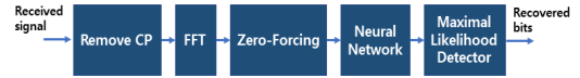
그림 6. 인공신경망 보조 제로-포싱 검파기의 구조 Fig. 6. Architecture of neural network aided zero-forcing detector
