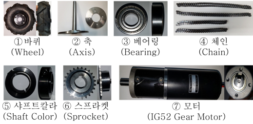
그림 6. 무인로봇 바퀴 연결부품 Fig. 6. Components of wheel connector
