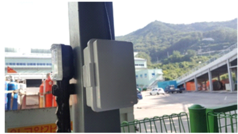
그림 9. 실외에 설치된 LoRa 기반의 센서 Fig. 9. LoRa-based Sensor placed outdoors
