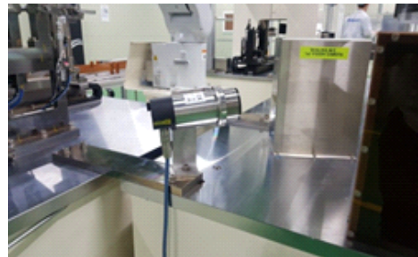
그림 6. 실링 온도 측정용 온도계 설치 모습 Fig. 6. Infrared thermometer for measuring sealing temperature
