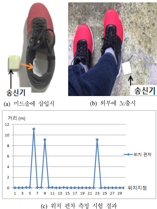
그림 4. 위치 편차 확인을 위한 시험 Fig. 4. Test for Checking Position Deviation. (a) when inserted into the midsole, (b) when exposed to the outside, (c) Position deviation measurement result.
