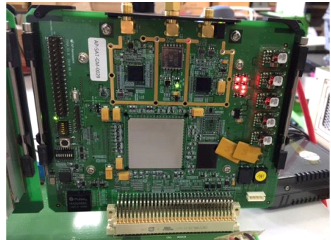
그림 4. 항재밍 기법 구현을 위한 모델 보드 Fig. 4. Modem board for anti-jamming scheme implementation
