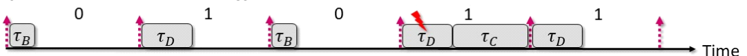
그림 1. (m, k) -패턴이 (0, 1, 0, 1, 1) 일 때 정적 기법의 SRE와 SDR에서 태스크 스케줄링 간트 차트. Fig. 1. Gantt chart of task scheduling in SRE and SDR of static technique when the (m, k) -pattern is (0, 1, 0, 1, 1).
