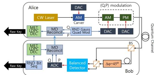
그림 1. 시분할 직교 호모다인 검출을 이용한 연속변수 양자암호기분배 시스템. CW Laser, 연속파 레이저; AM, 광 진폭 변조기; PM, 광 위상 변조기; DAC, 디지털 아날로그 변환기; ADC, 아날로그 디지털 변환기; BS, 빛의 가르개.
