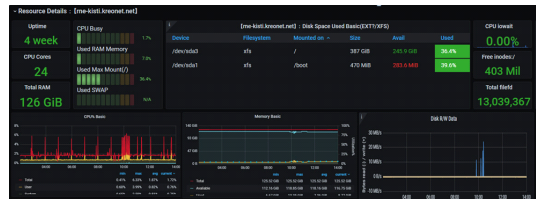
그림 12. Prometheus와 Grafana를 이용한 모니터링 시스템 Fig. 12. Monitoring System using Prometheus and Grafana
