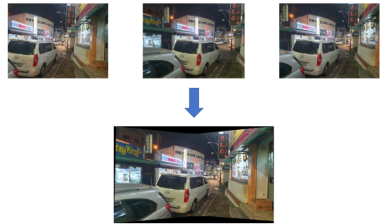
(좌: 해상도 640x480, 중: 해상도 1920x1080, 우: 해상도 1280x720, 아래: 스티칭 결과) 그림 11. 실험에 사용된 영상의 예시5 Fig. 11. Image Example 5 from the Experiments
