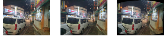
(좌: 해상도 640x480, 중: 해상도 1280x720, 우: 스티칭 결과) 그림 9. 실험에 사용된 영상의 예시3 Fig. 9. Image Example 3 from the Experiments
