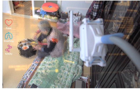
그림 1. 고령층 1인가구용 비접촉식 생체정보 모니터링 실증 예시 Fig. 1. An illustration of contactless biometrics monitoring testbed for a single elderly household
