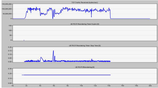
그림 12. PDCP 재정렬 타이머 만료 없는 case(cell 당 200UE) Fig. 12. Case without expiration of PDCP reordering timer (200 UEs per cell)
