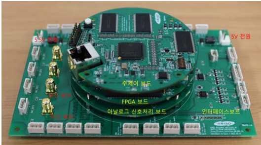
그림 15. 주제어보드, FPGA보드, 아날로그 신호처리보드 및 인터페이스보드 결합 Fig. 15. Stacking shape of main control board, FPGA board, analog signal processing board and interface board
