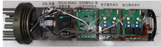
그림 16. 장거리 수중통신 모뎀 플랫폼의 전자부 Fig. 16. Electric part of long-range underwater modem platform
