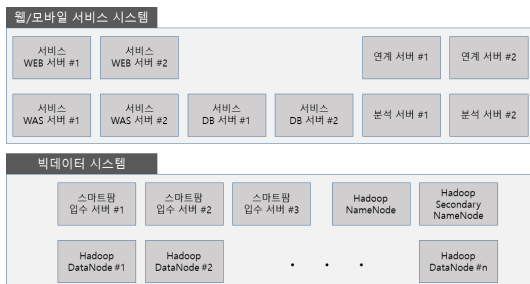
그림 2. 스마트팜 빅데이터 시스템 (온 프레미스) Fig. 2. Local systems of smartfarm bigdata platform (on premise)
