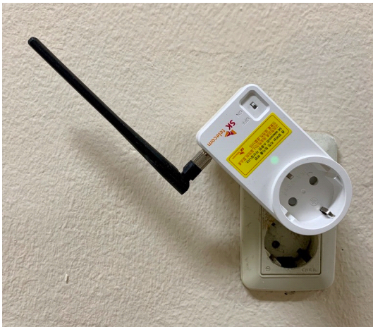
그림 1. CrowdQuake 감시 장치 설치 Fig. 1. Installing a CrowdQuake sensor
