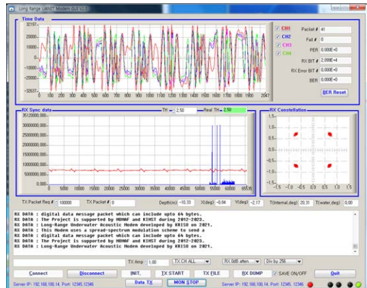
그림 19. 정상 크기 신호를 송신한 경우의 수신측 GUI 화면 캡처 Fig. 19. Screen capture of receiving modem GUI when transmitting modem sends with normal signal amplitude
