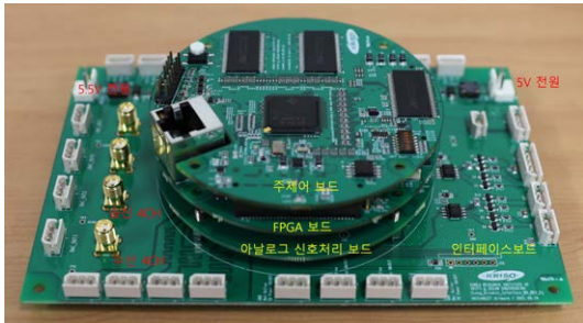
그림 5. 주제어보드, FPGA보드, 아날로그 신호처리보드 및 인터페이스보드로 구성된 신호처리부 Fig. 5. Signal processing unit composed with main control board, FPGA board, analog signal processing board and interface board
