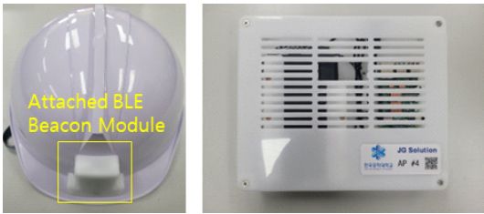
그림 13. 비콘 모듈이 내장된 스마트 안전모 및 BLE AP Fig. 13. Smart-helmet with beacon module and BLE AP
