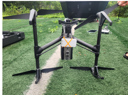
그림 2. 드론에 부착된 휴대용 무선랜 라우터 Fig. 2. Mobile Wi-Fi router attached to the drone
