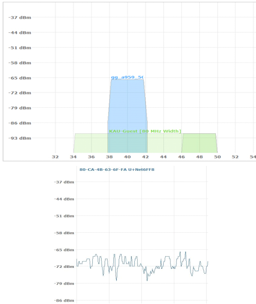
그림 3. 공개 소프트웨어 Homedale을 사용한 수신 신호 측정 (5 GHz, CH40) Fig. 3. Received signal measurement using the freeware Homedale (5 GHz, CH40).
