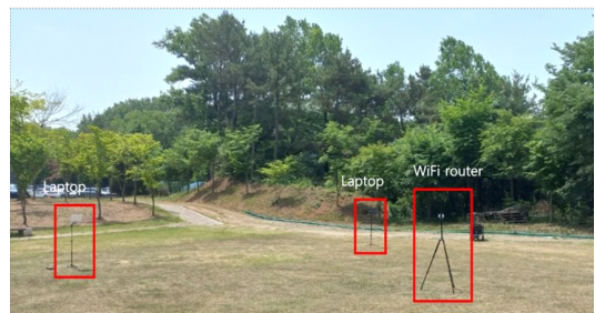
그림 5. 무선랜 송신기와 수신기 배치 Fig. 5. Placement of Wi-Fi transmitter and receivers.
