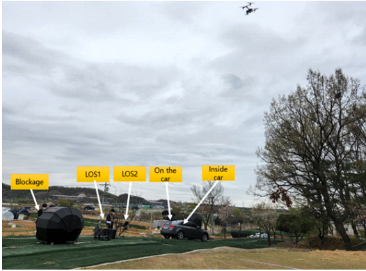
그림 17. 수평거리 및 고도에 따른 경로 손실 측정을 위한 수신기 배치 Fig. 17. Placement of Wi-Fi receivers for path loss measurement according to the ground distance and altitude.
