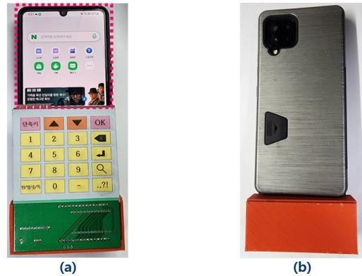
그림 4. 터치형 스마트폰에 부착된 검증 시스템 사진
