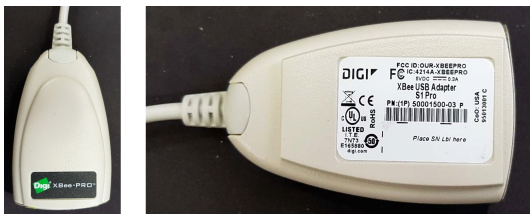
그림 17. 1:N 통신을 위해 PC에 장착된 지그비 리더기 (DIGI 社) Fig. 17. Zigbee Reader (DIGI Inc.) mounted on PC for 1:N communication
